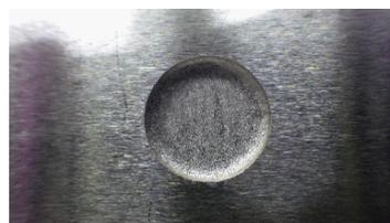
研磨拋光面積： $\phi 8\text{mm}$
