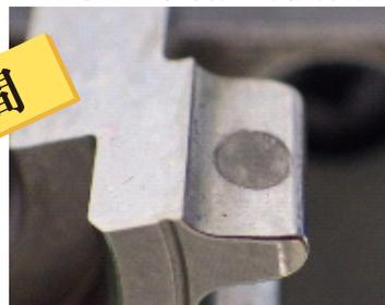
研磨拋光面積： $\phi 2\text{mm}$
